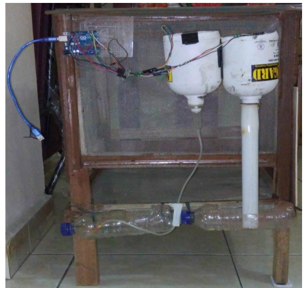
Gambar 21. Rangkaian Sistem Pemberian Pakan dan Minum Ayam Secara Otomatis Menggunakan Mikroontroller ATMEGA328
