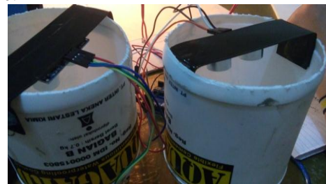
Gambar 10. Sensor Ultrasonik Pengukur Volume pakan dan Air
