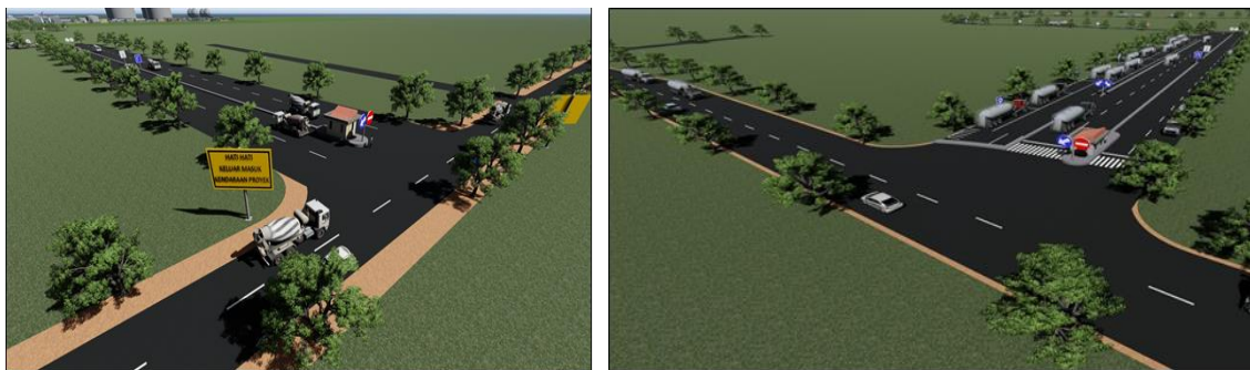
Gambar 2. Simulasi Arah Pergerakan Kendaraan Saat Kontruksi dan Operasional Awal Pembangunan Terminal LPG Refrigerated
