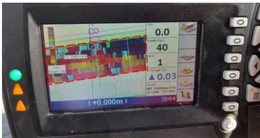
Gambar 7. Perekaman Progress Harian Data Kepadatan Tanah dengan 3D Machine Control Vibro Compactor
