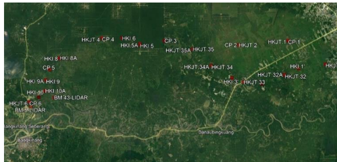
Gambar 4. Distribusi ICP LiDAR pada Rencana Jalan Tol Pekanbaru – Bangkinang
