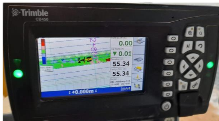
Gambar 9. Tampilan Panduan Control Box pada 3D Machine Control Motor Grader
