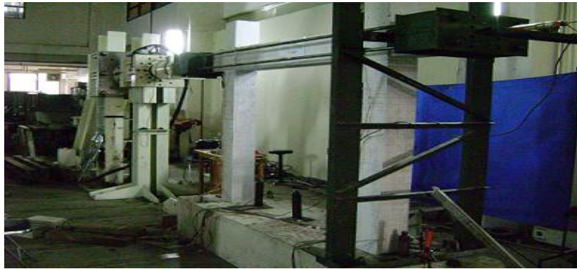
Gambar 3.6 Contoh Setup Pengujian Portal uji.
